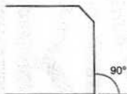
Figura 3 – Detalhe do ângulo de inclinação da peça de concreto
